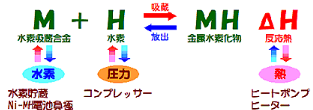
図1 水素吸蔵合金の仕組み[3]
